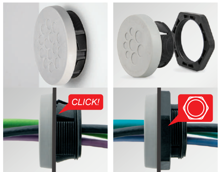
Montaje tipo 1: Encajado en el recorte Para espesores de chapa entre 1 – 2,5 mm
