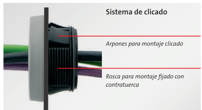
Montaje tipo 1: Encajado en el recorte Para espesores de chapa entre 1 – 2,5 mm
