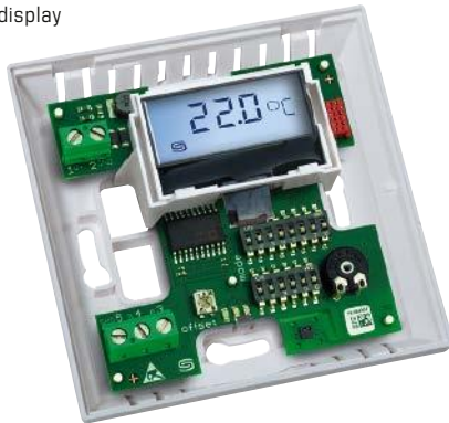
RTM1-Modbus sin display
