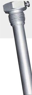
THR-VA-09 /xx Manguito de inmersión de acero inoxidable V4A [1.4571] sellado plano, cilíndrico, según DIN 228
