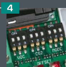
Interruptores DIP para el ajuste individual de rangos de medida, salida automática del punto cero y asignación del relé
