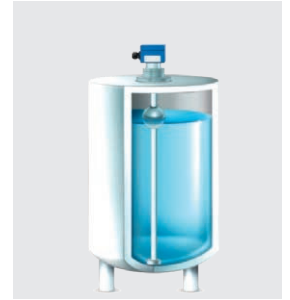
Vídeo "Medición de nivel mediante sensor de flotador de cadena Reed"
