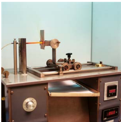
Ensayo del hilo incandescente a 960°C s/EN 61537.
