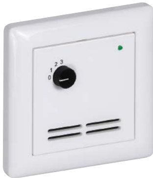
FSTFxxLD4 Ejecución con sensor, diodo luminoso (verde) y interruptor giratorio (4 niveles) (máx. 24 V AC / DC, máx. 130 mA)
