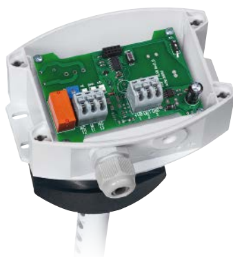
KLSW-W24 con inversor, UB = 24 V
