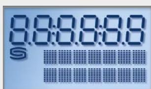
A través de la interfaz EtherCAT se puede programar el **indicador LCD**. Si solo se selecciona una magnitud de salida, la indicación se visualiza estáticamente, si se seleccionan varias, la indicación se visualiza cíclicamente en sucesión.
