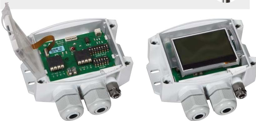
THERMASGARD® HFTM - Modbus - T3 Sensor de manguito con convertidor de temperatura
