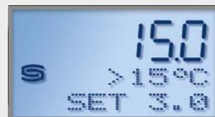
**Sobrepasado del umbral máximo del rango de medición** - Temperatura efectiva es superior a +15°C
