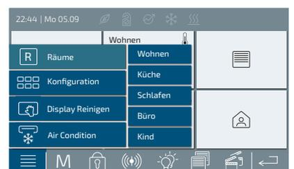
Controlador para el control de temperatura, ventiladores, luz y protección solar, regulador para interiores con pantalla táctil TFT en color, con conexión Modbus o W-Modbus (Wireless)
