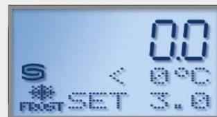
**Sobrepasado del umbral mínimo del rango de medición** - Temperatura efectiva es inferior a 0°C
