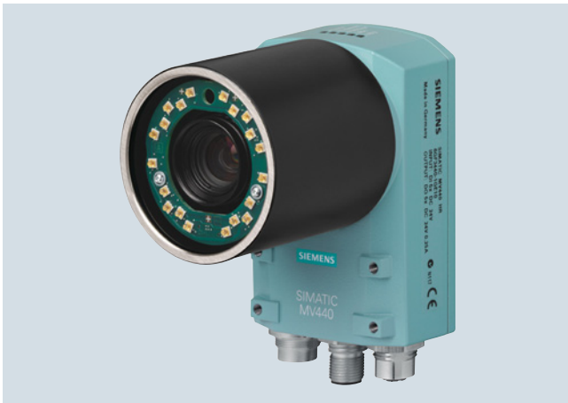
SIMATIC MV440 con iluminador anular incorporado y tubo protector D65 (el tubo protector se adquiere en calidad de accesorio)
