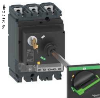
ComPacT NSX con mando rotativo prolongado instalado en la parte posterior de un cuadro de distribución, con la opción de cerradura y llave
