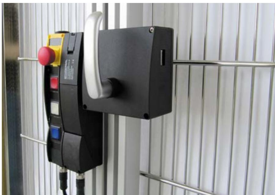
La imagen muestra la combinación con el BDF200 y un dispositivo de enclavamiento y bloqueo por solenoide AZM201, incluyendo el actuador de manilla B30 con el grupo de montaje como elegante solución para un resguardo de seguridad móvil. Gracias a esta unión entre el panel de mando BDF200 y el dispositivo de bloqueo por solenoide AZM201, el operador de la máquina puede disfrutar de un elevado nivel de ergonomía y confort.
