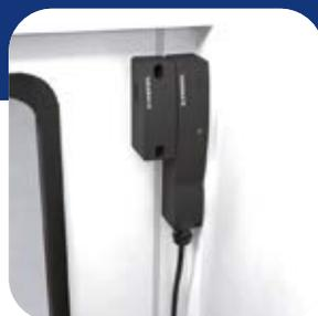
Todos los interruptores de seguridad del tipo 2 presentados en esta sección disponen por lo menos del tipo de protección IP67, y en combinación con un relé de seguridad correspondiente, pueden llegar a alcanzar el nivel de prestación (PL) d ó e según EN ISO 13849-1. Encontrará información para la selección de los relés de seguridad adecuados en el capítulo "Relés de seguridad" página 220.
