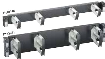
Paneles de guiado para cables de conexión El panel 1U gestiona 24 cables y el panel 2U gestiona 48 cables. Aunque se abre con facilidad es muy seguro ya que el dispositivo inteligente impide que los cables se caigan. También es posible tirar de un solo cable para extraerlo, si fuera necesario.
