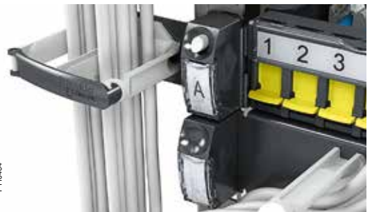
Anillos laterales para rack de 800 x 800 Anillos para gestión vertical de hasta 48 cables de conexión, fijados a cada lado del panel de guiado (o cualquier panel con Quick Fix). Disponibles para 1U y 2U.
