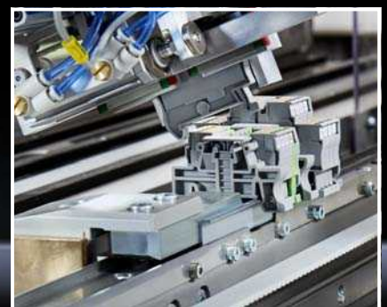
Montaje automatizado de bornes y marcaje mediante sistema de marcaje con láser
