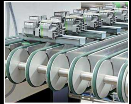
Unidad de clasificación y depósito intermedio para regletas de bornes producidas
