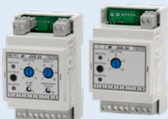
Los **termostatos de protección antihielo JVA 24 y JVS 24** son excelentes para evitar que las bobinas de calentamiento se congelen en las unidades de tratamiento de aire. La protección se basa en el control proactivo de la válvula por medio de la medición de temperatura. [Página 132](#)
