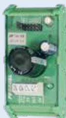
La **fuentes de alimentación JY de modo interruptor** es un convertidor multiusos de AC/DC a DC. Básicamente, es la única fuente de alimentación CC necesaria. Es útil como fuente de alimentación para los bucles de corriente. [Página 153](#)
