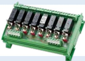
Las unidades de relé **RYM 8-KK** y **RYM 8-KK-O** tienen ocho salidas de relé que se pueden controlar manualmente o mediante el uso de una señal de entrada de 24 V DC. El control manual es útil para la puesta en marcha y el control manual en caso de averías. [Página 151](#)
