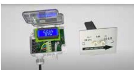
**Configuración del transmisor de caudal de aire Produal DPT-Flow-MOD**
