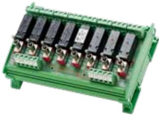
**Las unidades de relé RYM8-KK y RYM8-KK-0** tienen ocho salidas de relé que se pueden controlar manualmente o mediante una señal de entrada de 24 V CC o 0 V. El control manual ayuda, por ejemplo, en la puesta en servicio y en situaciones de avería. [Página 166](#)
