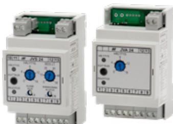
Los **termostatos de protección anticongelación JVA 24 y JVS 24** son una forma excelente de evitar la congelación de los serpentines calefactores en las unidades de tratamiento de aire. La protección se basa en el control proactivo de la válvula mediante la medición de la temperatura. [Página 146](#)
