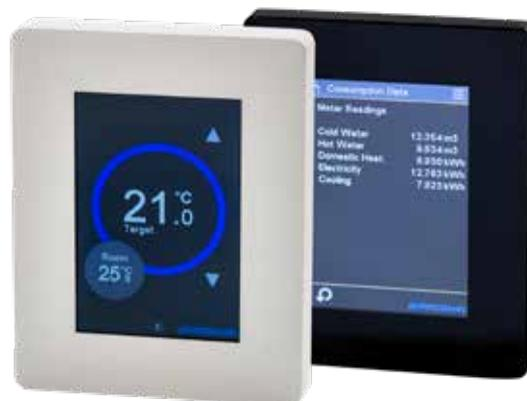
La vista de datos de consumo es una nueva función disponible en los modelos -CD. Esta vista puede mostrar, por ejemplo, detalles sobre el consumo de agua, energía y calefacción. El sistema BMS lee estos datos de los distintos sensores del edificio y los envía al controlador TRC-A-3A a través de Modbus o BACnet.
