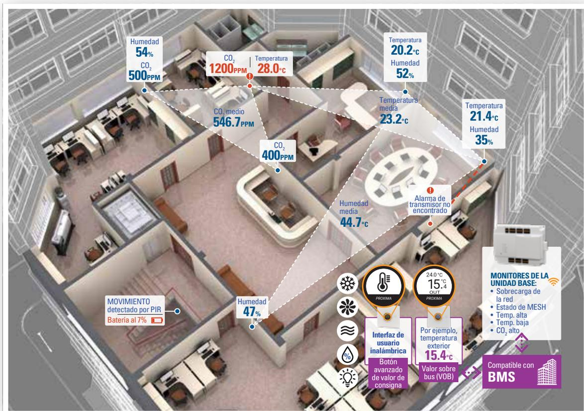
La plataforma funciona en la frecuencia mundialmente aceptada de 2,4 GHz, reconocida en diversos entornos. Su asombrosa multifunción ofrece amplias posibilidades y opciones a los integradores de sistemas. La aplicación móvil MyTool permite una puesta en servicio, supervisión y actualización de la red sencillas. Todos los mensajes de la red están cifrados con el estándar AES-128.
