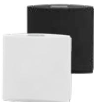
El **sensor de temperatura ambiente RS**, con carcasa negra o blanca de clase de protección IP30, es una solución elegante, por ejemplo, para espacios públicos. El sensor proporciona un intervalo de medición de temperatura ampliado de -30...+70 °C y una precisión de medición mejorada mediante una conexión de 4 hilos. [Página 135](#)
