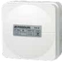
**EITH 5** es un producto versátil que se utiliza cuando la salida del controlador para la carga no es lo suficientemente potente. El TH 5 es un accionador montado en superficie que puede accionar varios actuadores térmicos conectados en paralelo. La señal de entrada del accionador puede ser cualquier señal de 5...30 V (proporcional al tiempo) destinada al control del actuador térmico. [Página 167](#)
