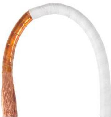
**Los hilos Litz estan formados por una agrupación de finos hilos de cobre, con una capa de esmalte que los aisla entre si y se utilizan amplia gama de aplicaciones que requieren buena flexibilidad y rendimiento de alta frecuencia.**
