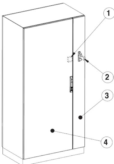
Este tipo de armario normalmente se une a otros módulos en batería y para responder a los requisitos NEM se requiere el uso del kit de enclavamientos que impida la apertura de las puertas de los armarios unidos en batería, si con anterioridad no se abre la puerta prioritaria.
