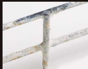
Acabado galvanizado en caliente estándar después de 600 horas
