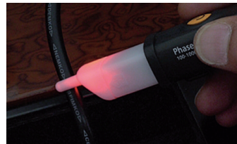
Encendido LED rojo con tensión detectada
