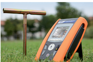
EARTH medida de la resistencia de tierra con picas (Telurómetro)
