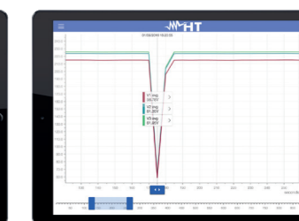
Ejemplo de visualización Registro efectuado (Evidentes huecos de tensión)
