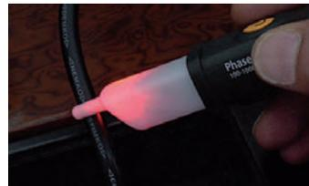
Encendido LED rojo con tensión detectada
