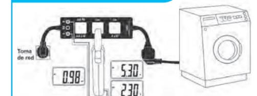
LINESPLITTER permite también la realización de medidas de tensión L-N, L-PE o N-PE e Intensidad a la vez (vea la figura superior) por lo que si utilizamos una pinza Vatimétrica podremos además de ver la tensión e intensidad, el consumo generado por el receptor en examen.
