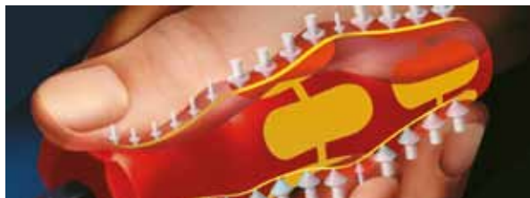
La amplia superficie de contacto, con una alta fricción contra las zonas blandas, garantiza una elevada transmisión de fuerza en el momento de agarre.
