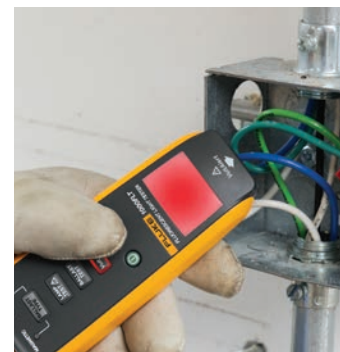
Comprobación rápida de presencia de tensión sin tocar conductores bajo tensión.
