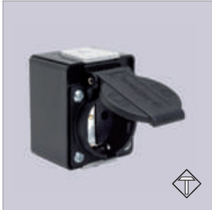
N.º 1461.007 = NEGRO Base estanca con tapa. Material: Thermoplast. 16 Amp. 250 V. Norma DIN 49440.
