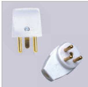
N° 853 Clavija bipolar con t.t. Sistema danés. 10 Amp. 250 V. Color: BLANCO.
